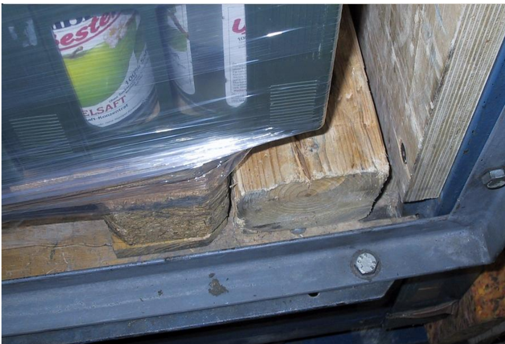
Abbildung 6: Verrutschte Getränkekiste infolge unzureichender Sicherung des Fußbereichs
