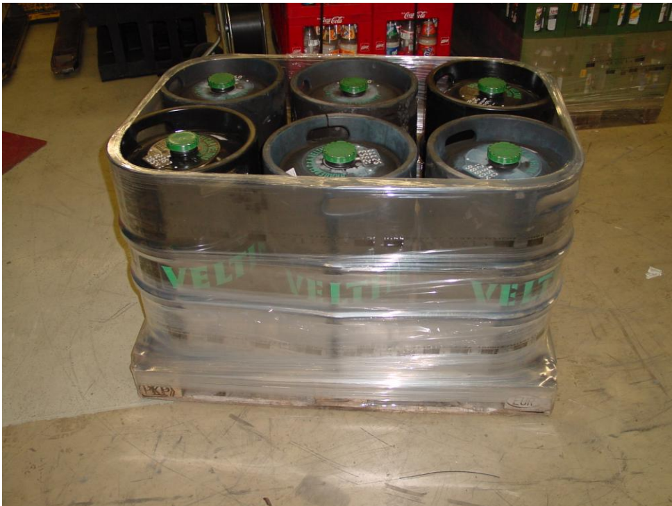
Abbildung 5: Sicherung von Fassbiereinheiten mittels Stretchen
