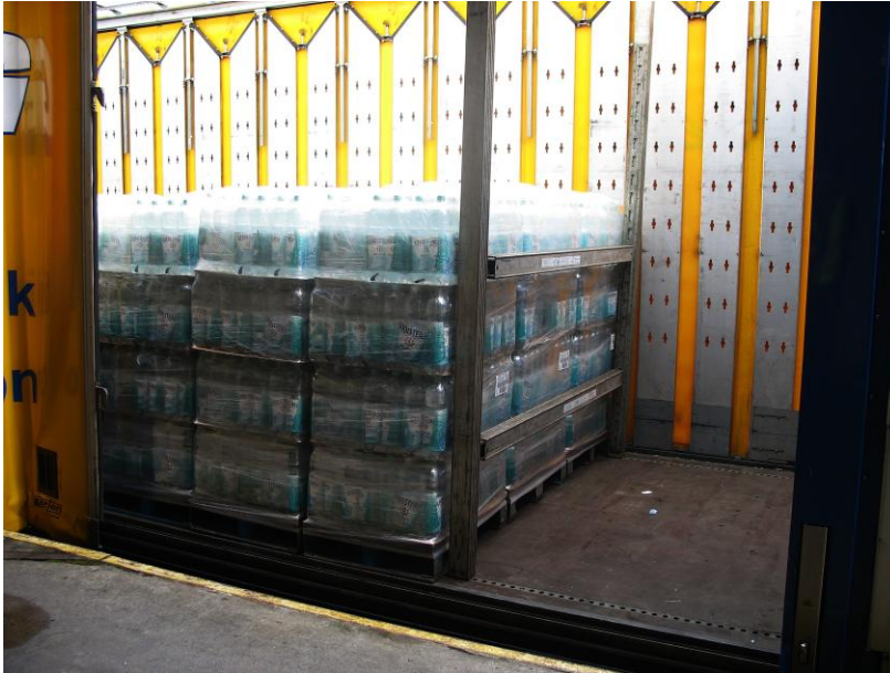
Abbildung 15: Rückwärtige Sicherung mittels Balkensystem
