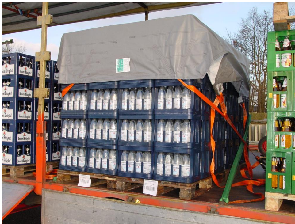
Abbildung 12: Niederzurrung einer Kastenladung mit Ladegutsicherungsplane
