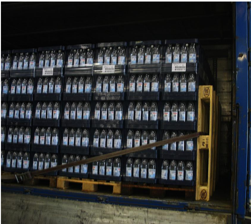
Abbildung 16: Rückwärtige Sicherung mittels Kopflashing
