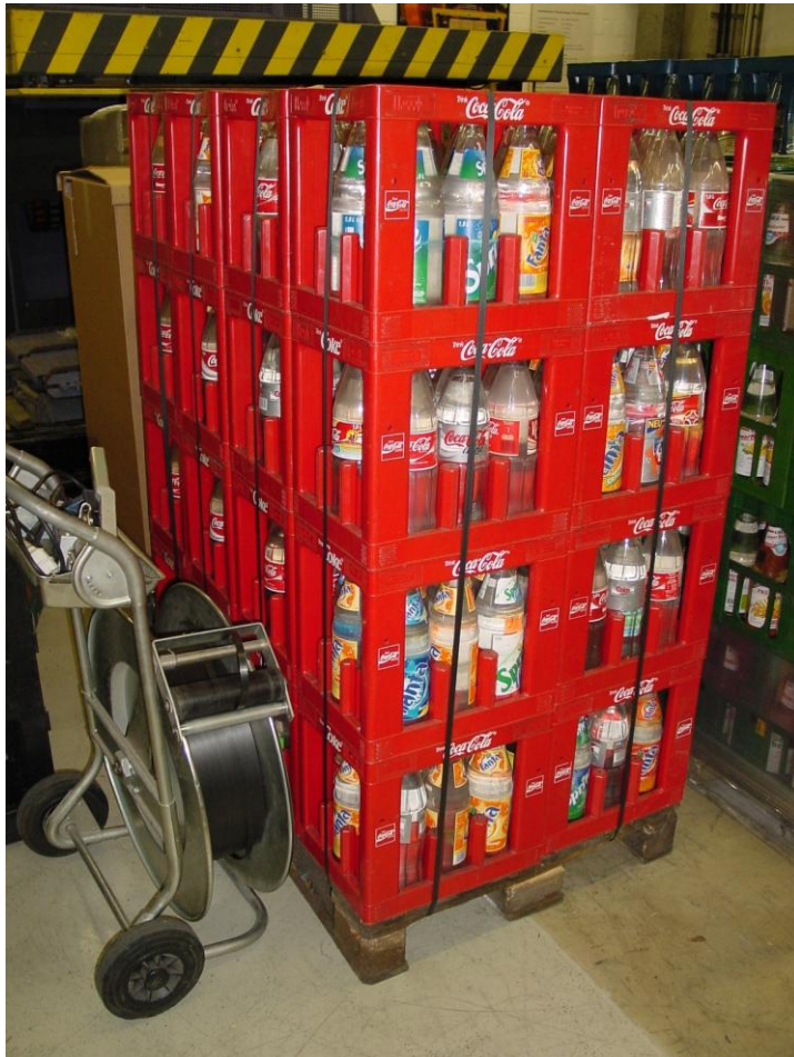
Abbildung 7: Sicherung von Kastenware mittels Umreifung
