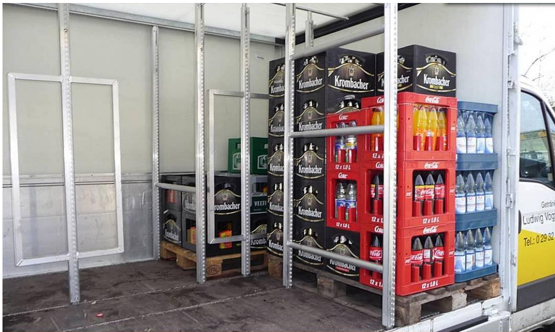
Abbildung 20: Ladungssicherung mittels Sperrstangen
