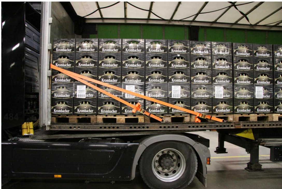
Abbildung 10: Beispielhafte Absicherung der Stirnwand
