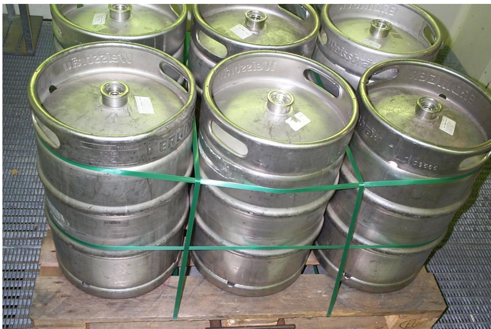
Abbildung 9: Sicherung von Fässern mittels Umreifen
