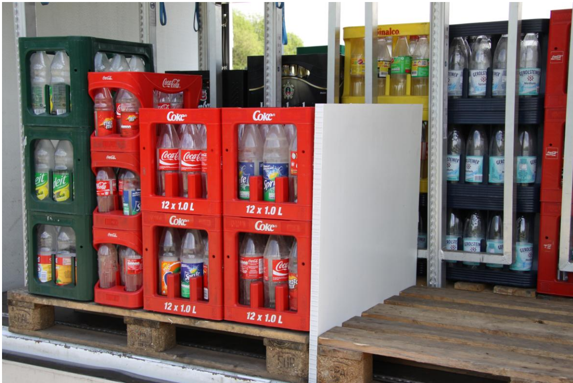
Abbildung 21: Gefachbildung mittels Platten bei Kleinverteiler-Fahrzeugen; Rückwärtige Sicherung mittels Sperrstangen
