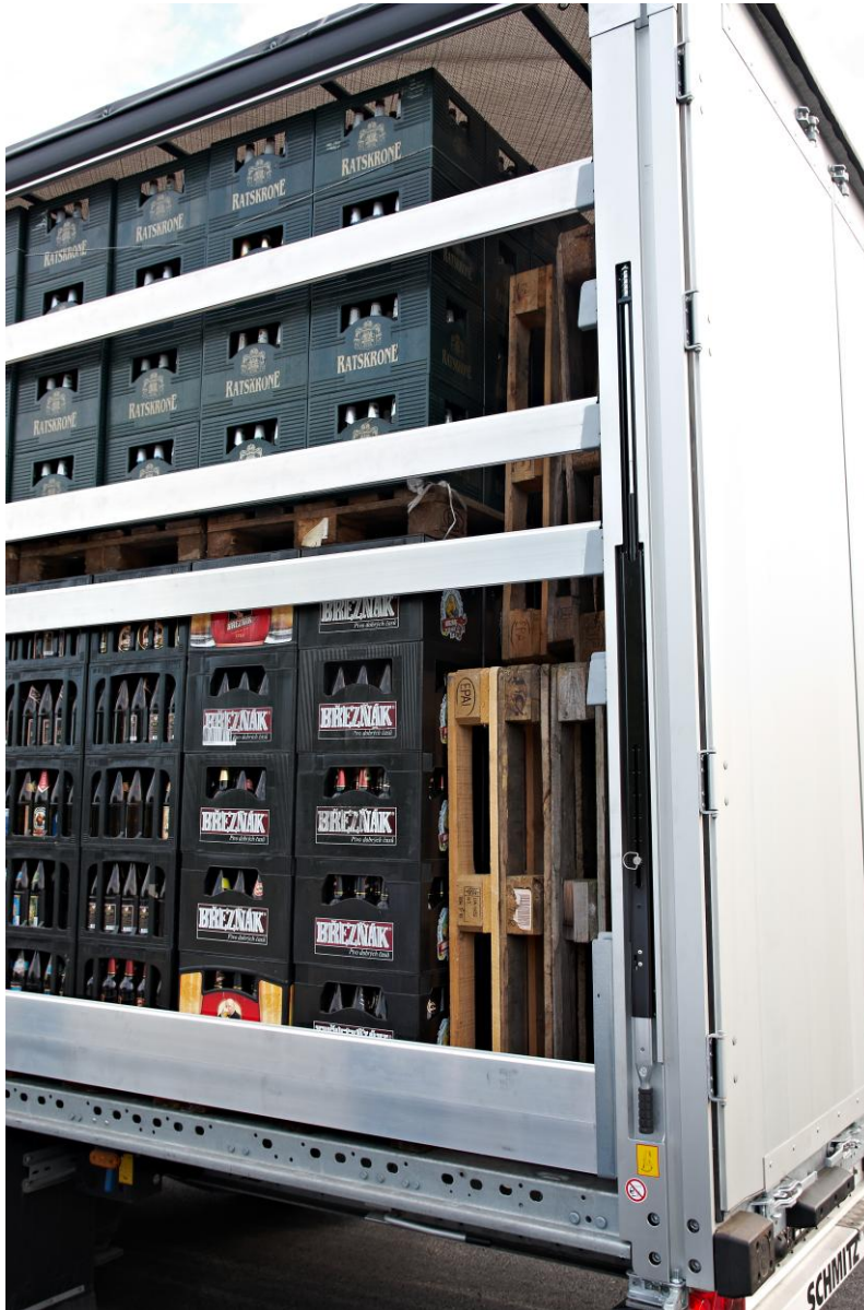
Abbildung 17: Rückwärtige Sicherung mit Paletten
