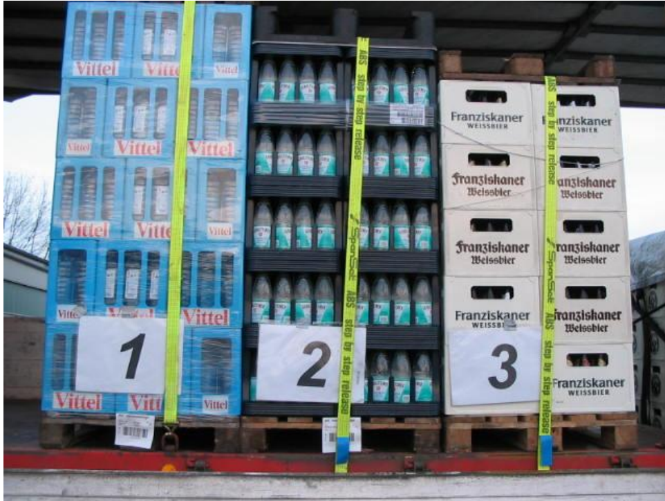
Abbildung 11: Niederzurrung einer Kastenladung mit umgedrehter Palette und einem Gurt je Ladereihe
