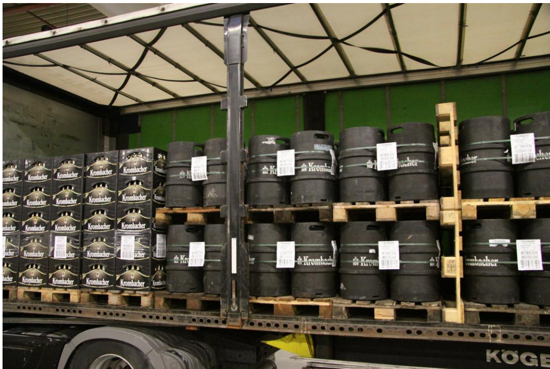
Abbildung 19: Abschottung von Fassware durch Paletten
