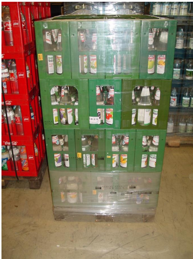
Abbildung 4: Sicherung von Kastenware mittels Stretchen
