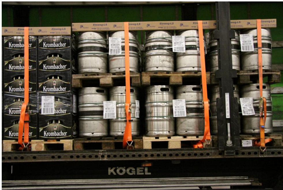
Abbildung 13: Niederzurrung einer Mischladung mit einem Gurt je Ladereihe
