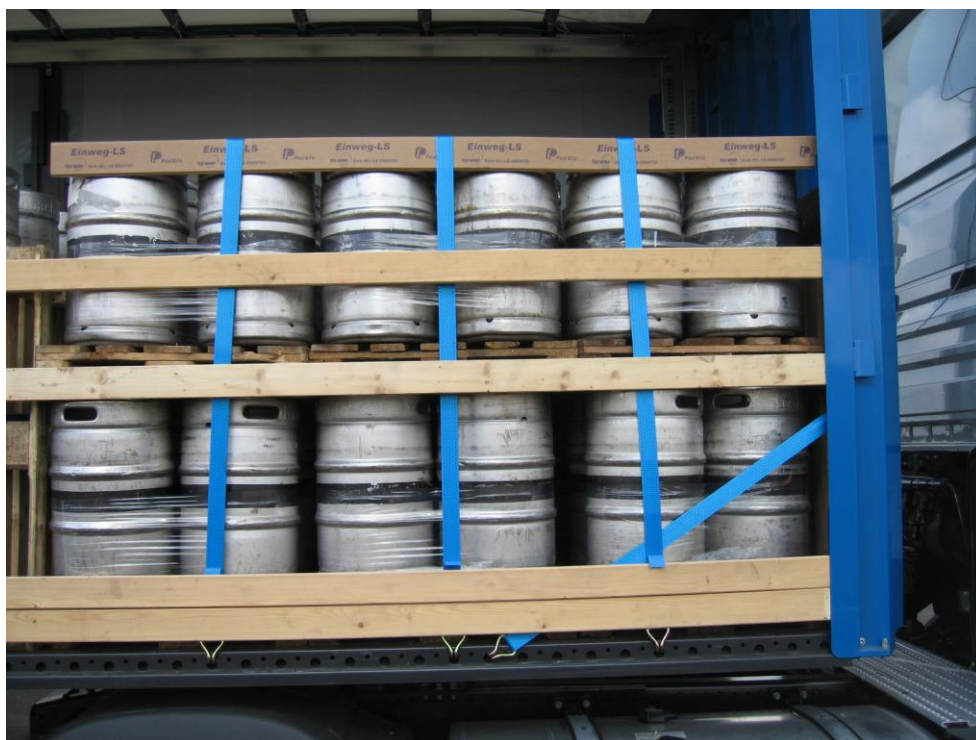
Abbildung 14: Niederzurrung mit Kantenschutzwinkel
