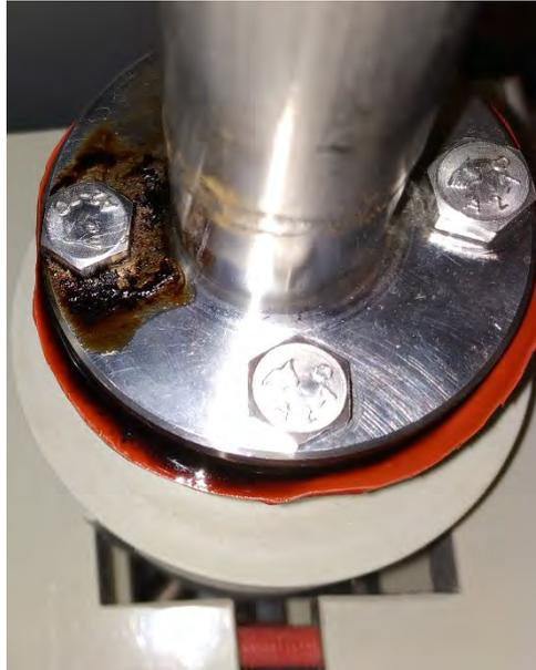
Abbildung 8: aufgrund einer kleinen Leckage ausgetretene und angetrocknete Bierwürze an Verschraubung des Reaktors.
