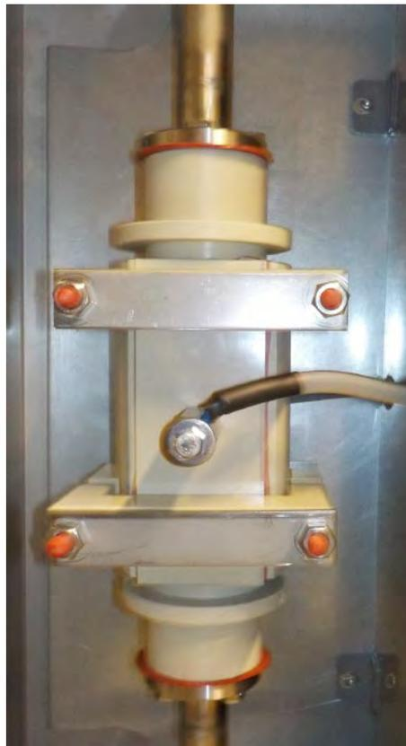
Abbildung 11: PEF-Reaktor, Ansicht außen
