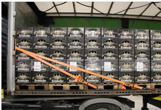
Abb. 3: Absicherung der Stirnwand
