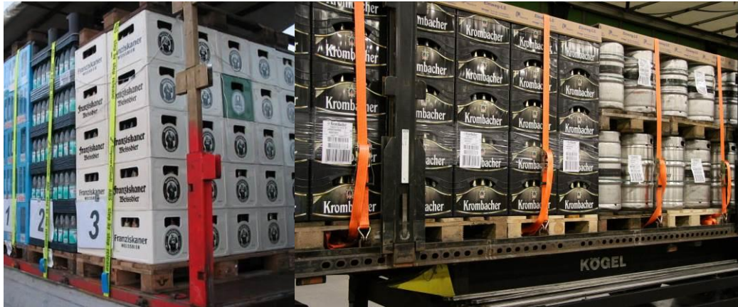
Abb. 4 & 5: Zur Stabilisierung und Zurrung sind Paletten oder geeignete Kantenschutzwinkel erforderlich. Aufgrund der Elastizität der Kunststoffkästen muss hierbei eine Holzpalette oder ein anderes Hilfsmittel zur Krafteinleitung des Zurrmittels in die Ladeeinheit von oben benutzt werden. Auch Fassladungen können derartig gesichert werden.
