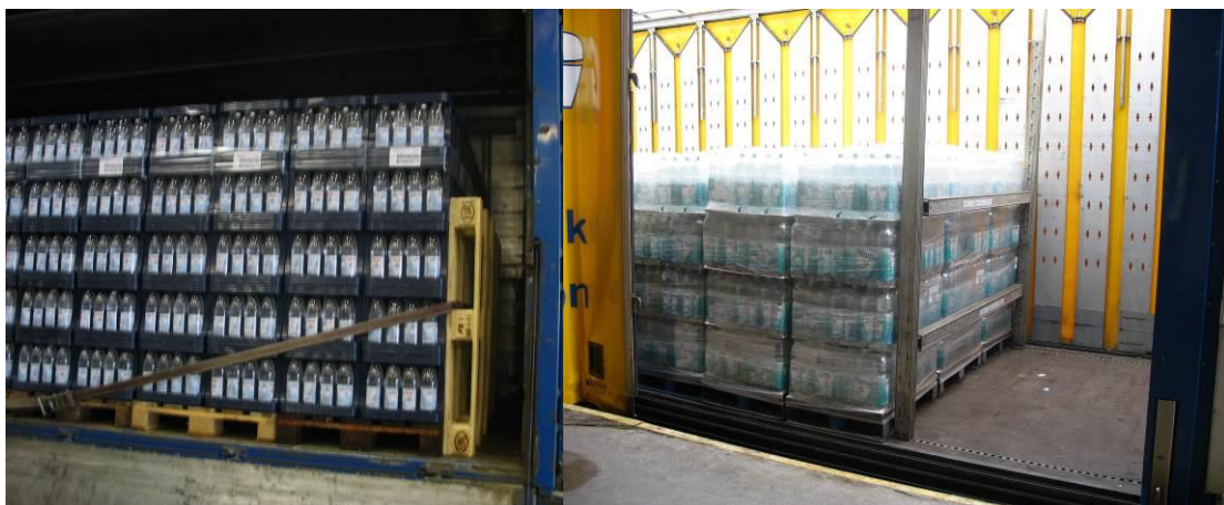
Abb. 6 & 7: Kopflashing für rückwärtige Sicherung und feste Balkensysteme
