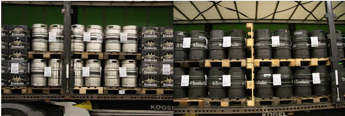
Abb.2: Bei Fass-Vollausladungen können Paletten helfen
