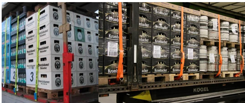
Рис. 4 & 5: Для стабилизации и блокировки необходимы паллеты или подходящий угловой профиль
