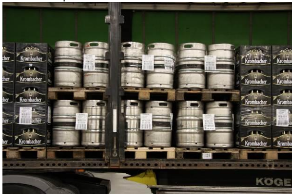
Рис. 1: Правильно сформированный груз из кег и ящиков
