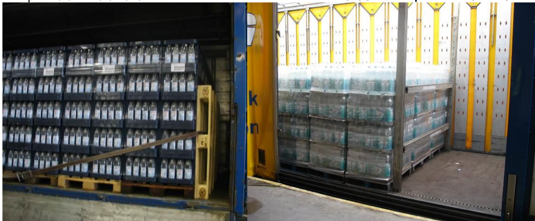
Рис. 6 & 7: Паллета, закрепленная ремнями, и конструкция из распорных балок для фиксации груза со стороны заднего борта.
