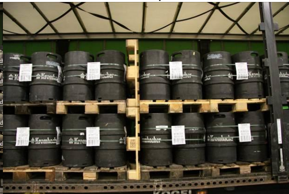
Рис. 2: Паллеты в качестве разделительных перегородок при перевозке кег
