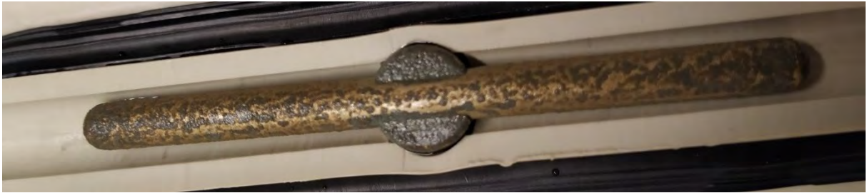
Abbildung 4: Elektrode mit Belag nach Versuch bei 3.130 Volt Pulsspannung und Bierwürze als Medium.
