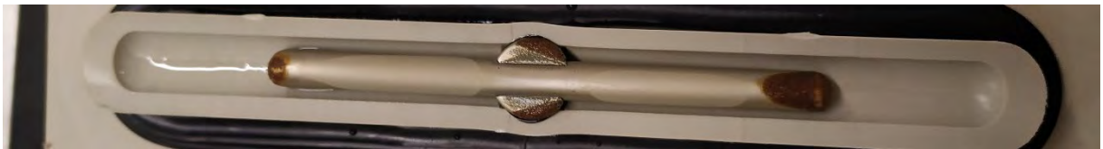
Abbildung 5: Komplementäre, gegenüberliegende Elektrode nach Versuch mit 3.130 Volt Pulsspannung.
