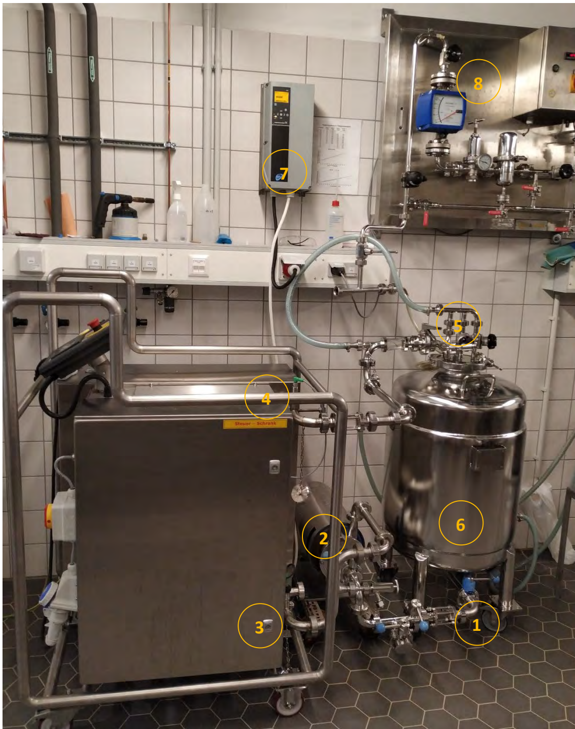
Abbildung 1: Technischer Aufbau für Propagationsversuche, hier in Reinigungs-Konfiguration:
