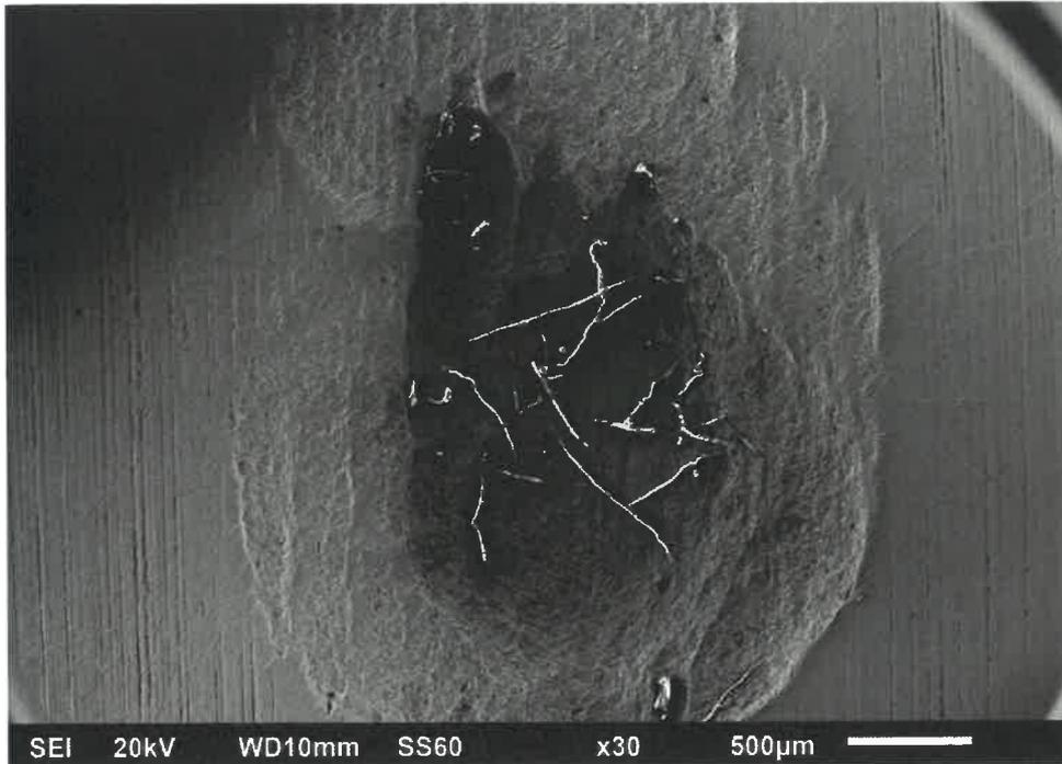
Abbildung 23: REM Darstellung von durch Natriumhypochlorid erzeugte Korrosion
