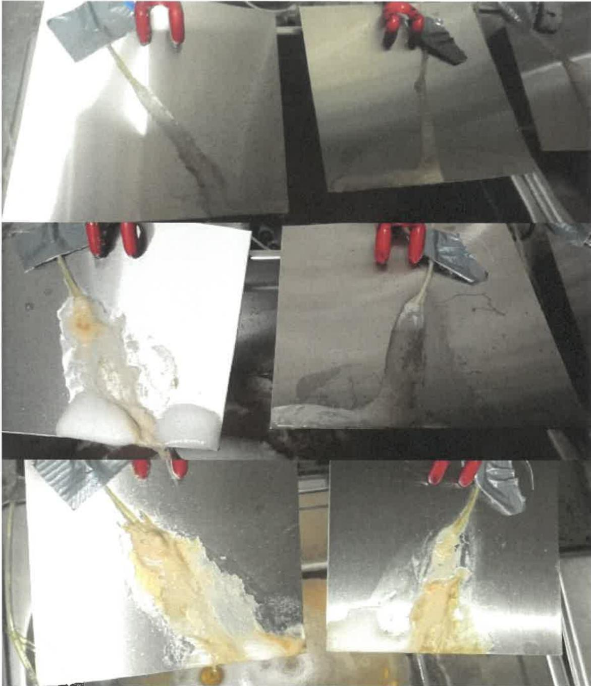
Abbildung 10: Biofilmwachstum in 3 Stufen (Versuch 8)
