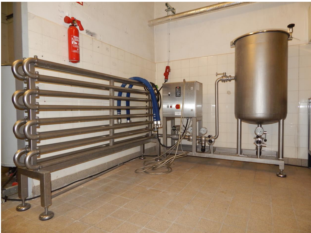
Abbildung 9: Pumpenteststrecke am Aufstellungsort in der Studienbrauerei
