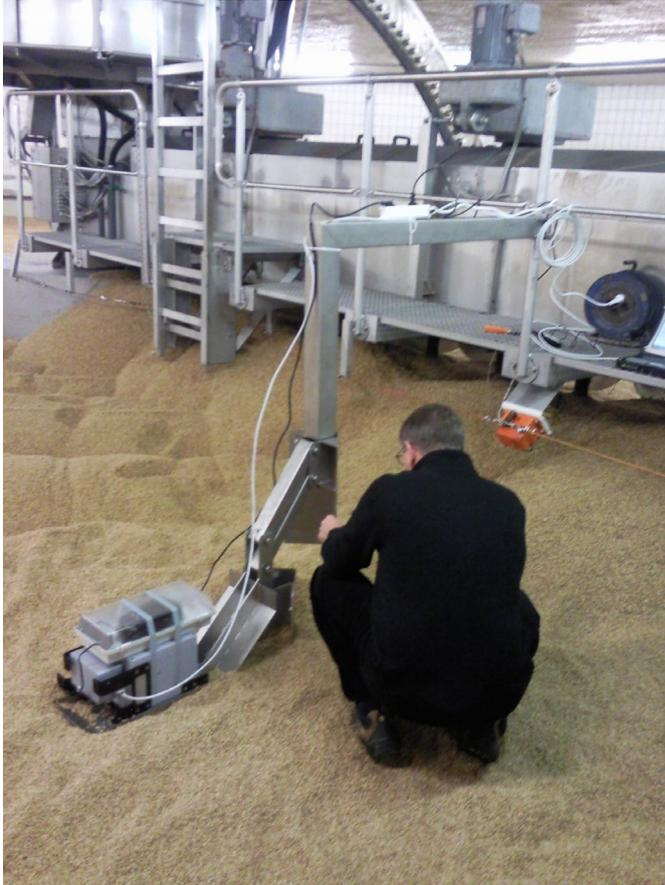
Abb. 14: Einsatz eines gekapselten Spektrometers MSC 611 - 1.5 in einem industriellen Keimkasten
