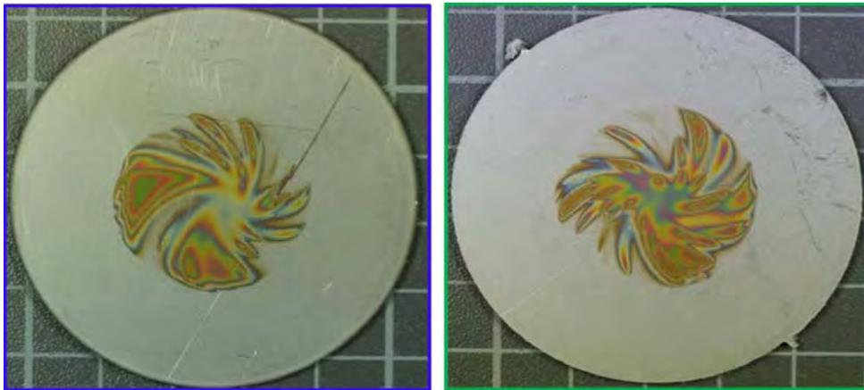
**Abb. 76:** Aussehen der Prüfkörperoberflächen nach den Polarisationsversuchen in Desinfektionsmedium 4 zur Darstellung des Einflusses der Vorbeanspruchung in ECA-Anolyt (blau: A-NB-4-4-StHW-unbeansprucht; grün: A-NB-4-4-StHW-andere Charge)
