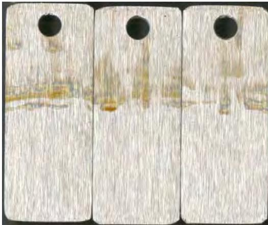
**Abb. 37: Korrosion im Bereich der Dreiphasengrenze**
