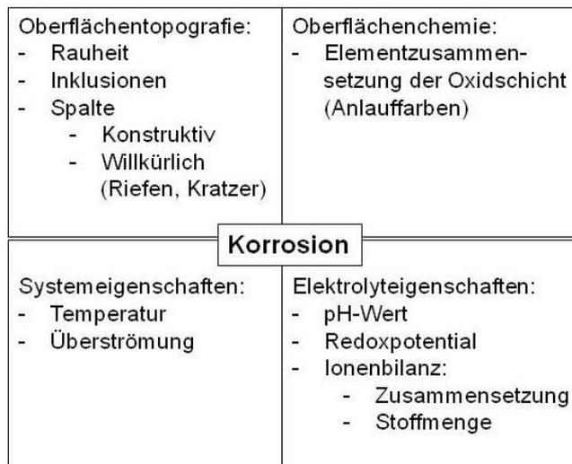
**Abb. 1: Einflussgrößen der Korrosivität metallischer Werkstoffe**
