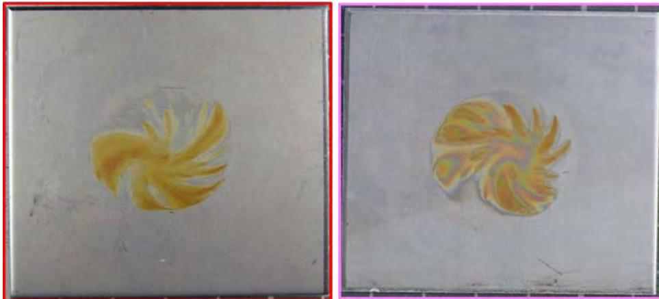
**Abb. 75:** Aussehen der Prüfkörperoberflächen nach den Polarisationsversuchen in Desinfektionsmedium 4 zur Darstellung des Einflusses der Vorbeanspruchung in ECA-Anolyt (rot: A-NB-4-4-StHW-Lang.ausl.-5-50; magenta: A-NB-4-4-StHW-Lang.ausl.-10-100)
