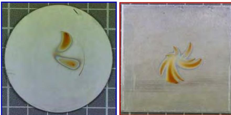
**Abb. 81: Aussehen der Prüfkörperoberflächen nach den Polarisationsversuchen in Chlordioxid zur Darstellung des Einflusses der Vorbeanspruchung – Teil I**
