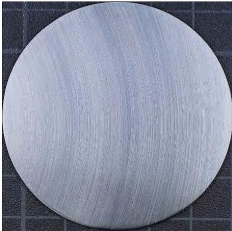
**Abb. 40: Prüfkörper mit geschliffener Oberfläche vor den elektrochemischen Messungen**
