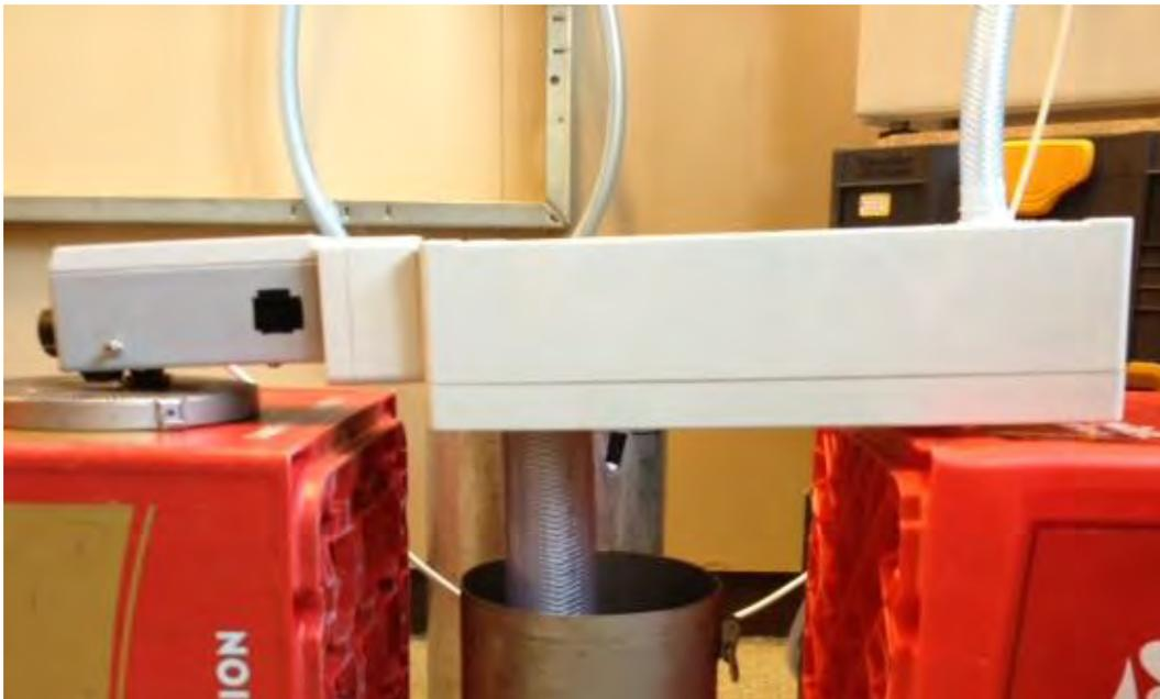
Abbildung 4 Ionisationsmodul System 1 für die Belüftung der Nassweiche
