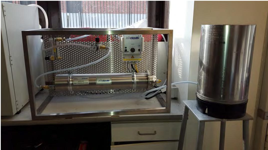
Abbildung 29 Ionisationsmodul für Nassweiche System 3
