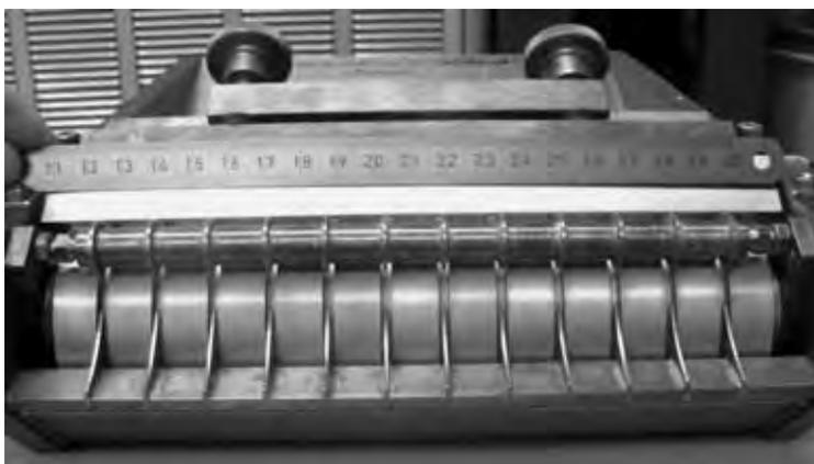
Abbildung 42: Leimwalze für Streifenbeimung
