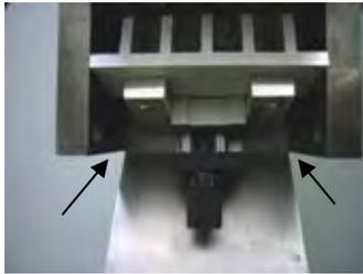
Etikett im Leerlauf betrieben, so wurde die Einheit selbst, anstatt dem Etikett, mit Leim versehen (siehe: Bild e), welcher im Nachfolgenden auf der Etikettenoberseite aufgebracht wurde, was die später angeordneten Gummiwalzen wiederum unerwünschter Weise mit Leim verklebte.
