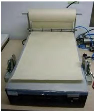
Abbildung 48: K 303 Control Coater-Modell 625
