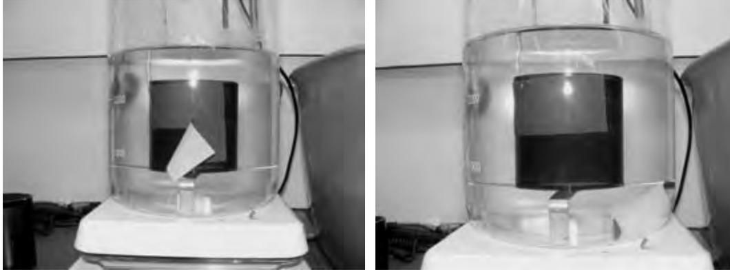
Abbildung 104: Ablösen des überlappenden Etiketts (links), zeitlich verzögertes Ablösen des unterlappenden Etiketts
