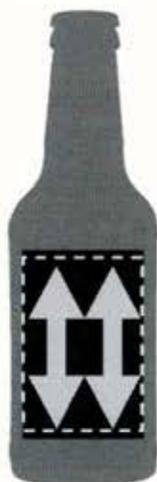
Abbildung 45: Nassdehnung parallel zur Flaschenachse
