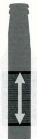
Abbildung 46: Nassdehnung auf einer homogenen Klebstoffschicht (Bereich 1)
