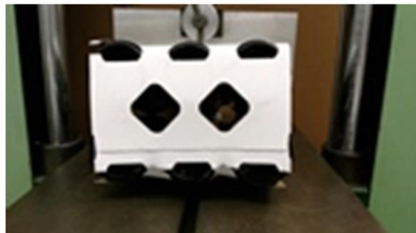
Ende der Prüfung bei aufgerissenem Boden
