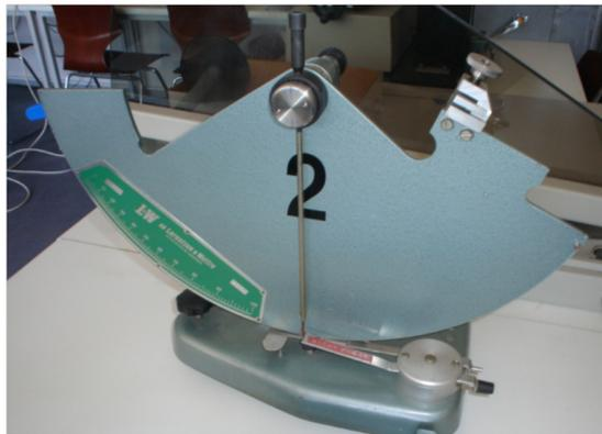
Abb.: Prüfgerät zur Bestimmung der Durchreißfestigkeit
