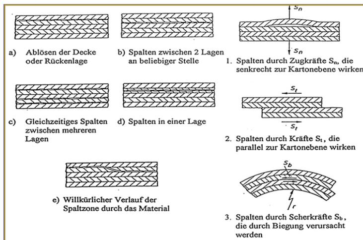
Abb.: Verschiedene Möglichkeit zur Spaltung von Kartonmaterial
