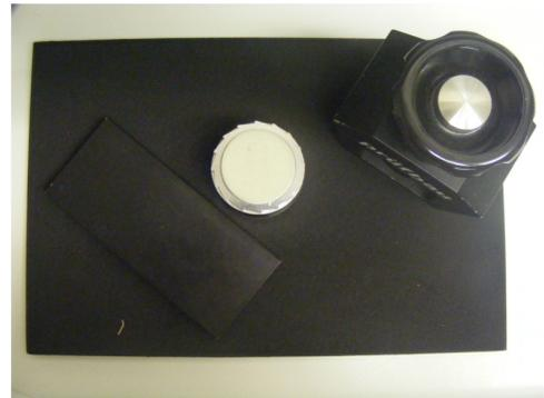
Nach dem Test erfolgt eine visuelle Beurteilung. Nach 400 Hüben sollen keine Scheuerspuren erkennbar sein.
