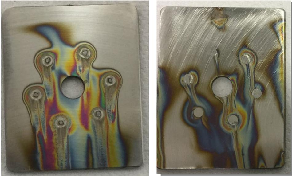
**Abb. 26: Die Morphologie der Korrosion des Werkstoffes 1.4301 in der Metall-Metall- (links) und Metall-Polymer-Spaltanordnung (rechts) in den elektrochemischen Untersuchungen – Teil I**
