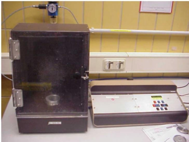
Abb. 18: Prüfgerät Ausbeulfestigkeit
