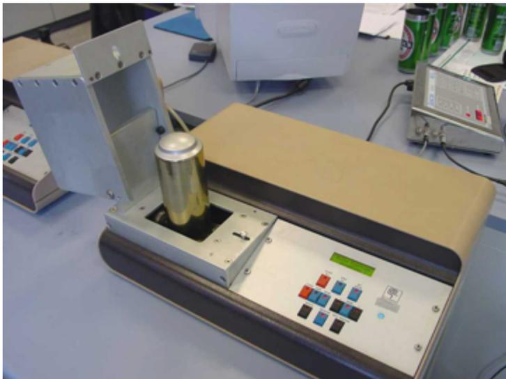
Abb. 6: Prüfgerät Ausbeulfestigkeit und Dichtigkeit
