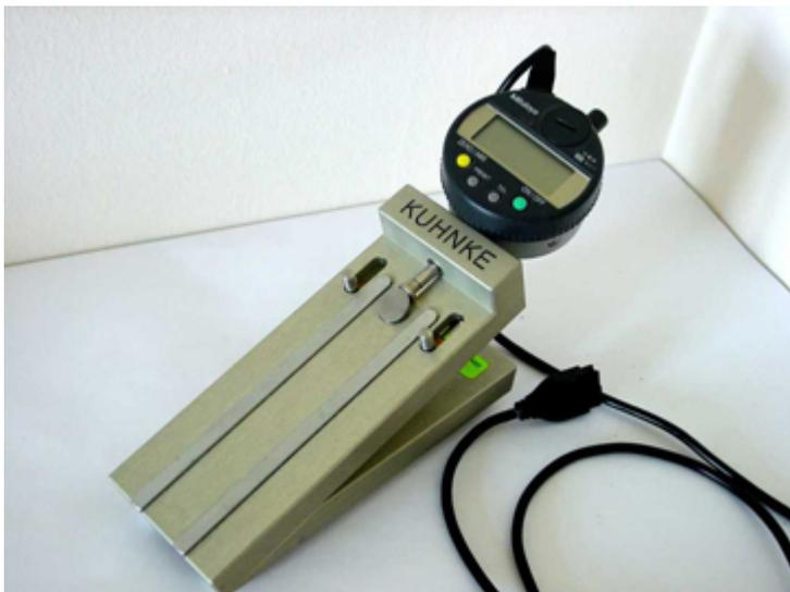
Abb. 2: Prüfgerät Bördelbreite
