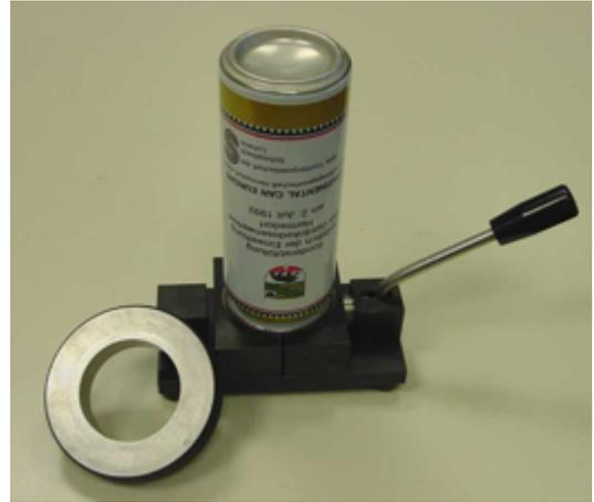
Abb. 4: Prüfgerät Rumpfeinzug-Innendurchmesser variable Prüfung
