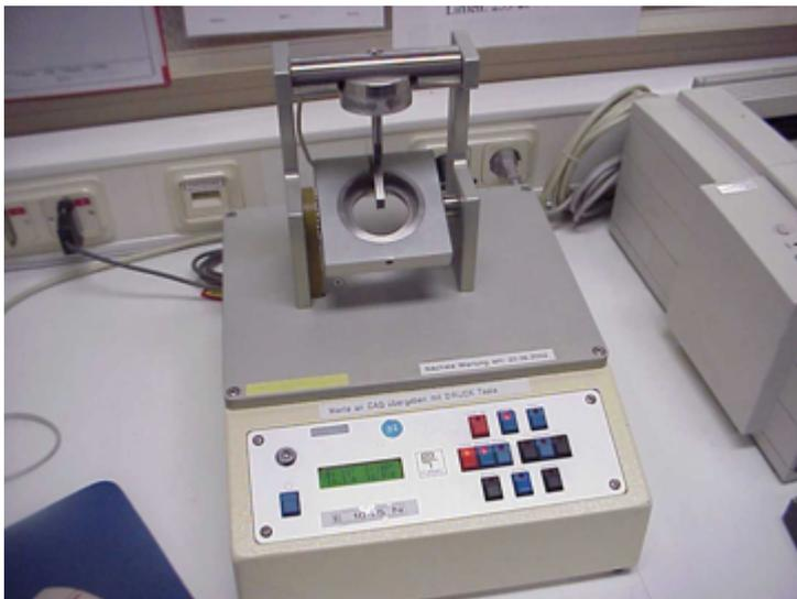
Abb. 19: Prüfgerät Aufreißkraft
