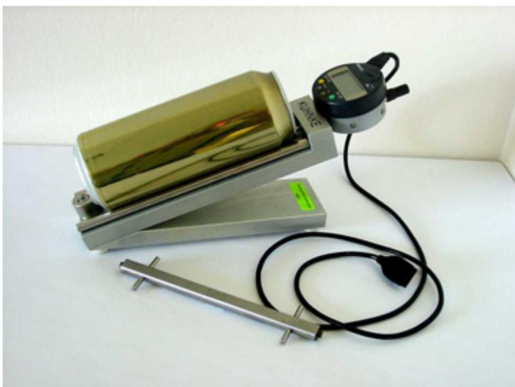
Abb. 1: Prüfgerät Dosenhöhe
