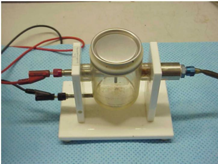
Abb. 17: Prüfgerät Porigkeit Innenlackierung
