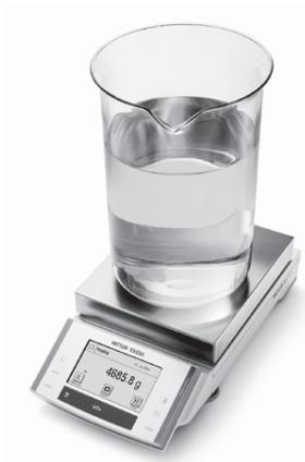
4-4502-00 **Präzisionswaage PG 8001-S**
