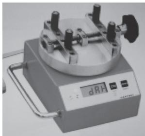
7-7200-00 **Torque-Tester Typ CAPTEST**
