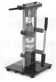
7-4300-00 **Luft- und CO<sub>2</sub>-Meßgerät Modell 7000**
